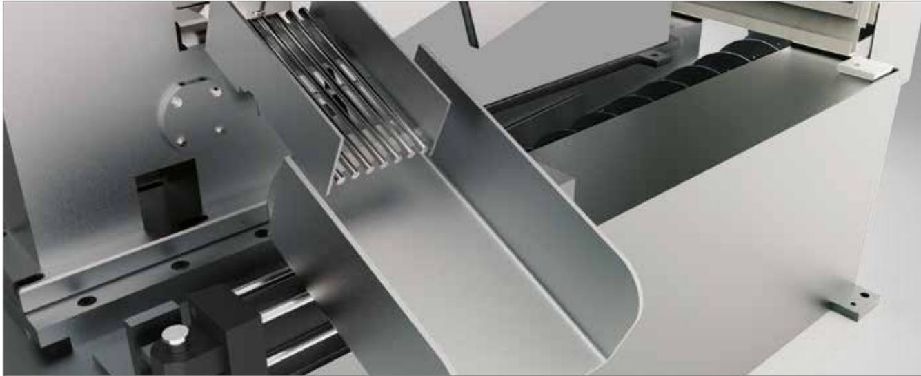
\_ Retroceso automático del alimentador al finalizar cada corte para evitar el roce con el material.
