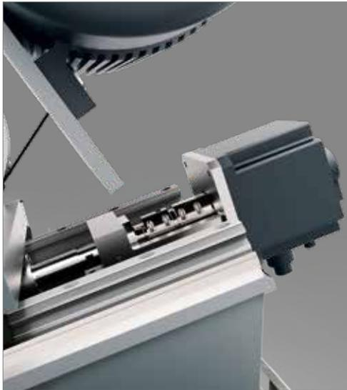
\_El cabezal operador se desliza sobre guías lineales y patines de recirculación de bolas.
