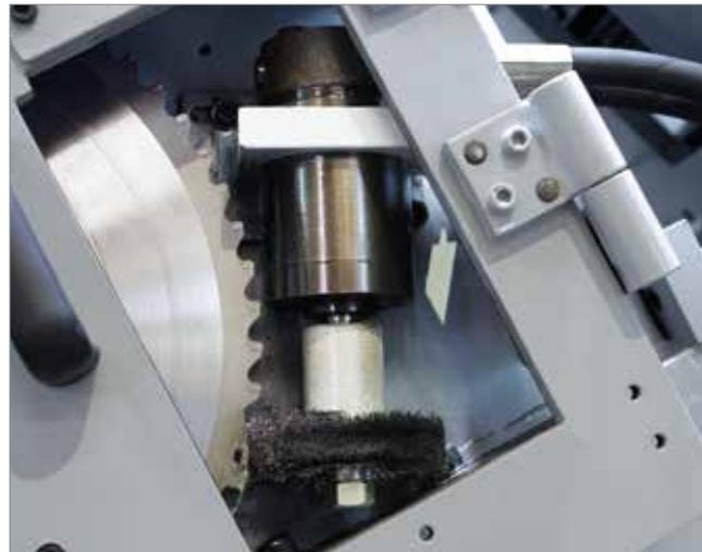
\_Lubricación automática de todas las partes móviles para garantizar su funcionamiento correcto. La lubricación puede temporizarse mediante el control de la máquina.
