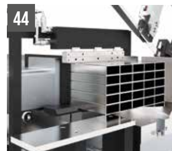
SHARK 452-1 SXI evo - Morsa verticale idraulica per tagli a fasci max. 450x180mm
