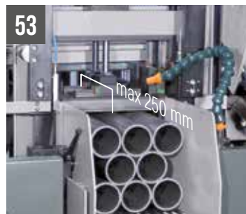
53 SHARK 230-1 NC HS 5.0 Morse verticali idrauliche per tagli a fasci (max 230x230 mm)
