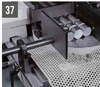
SHARK 332-1 NC 5.0 Guida regolabile scarica pezzi
