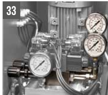
SHARK NC 5.0 Regolatore pressione morsa idraulica
