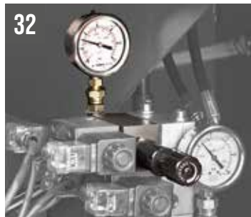
SHARK SXI evo Regolatore pressione morsa idraulica
