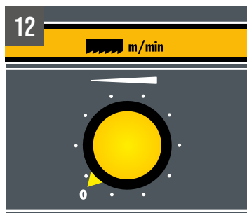
12 Variatore elettronico di velocità della lama
