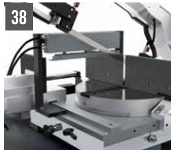
SHARK 382-1 SXI evo - Morsa verticale idraulica per tagli a fasci max. 380x160mm
