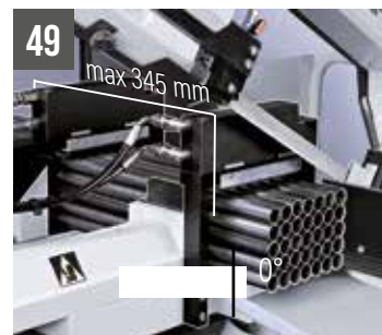
49 SHARK 281 NC 5.0 / 282SXlevo - Morse verticali idrauliche per tagli a fasci (max 170x130 mm)
