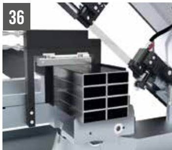
SHARK 281 SXI evo - Morsa verticale idraulica per tagli a fasci max. 170x130mm
