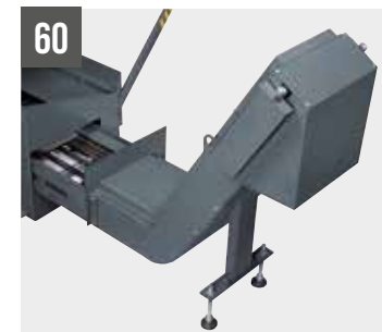
60 Evacuatore di trucioli motorizzato
