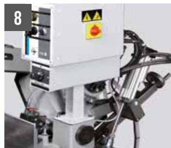
8 SHARK 282 - KIT CCS Cut Control System (dispositivo per taglio senza operatore)
