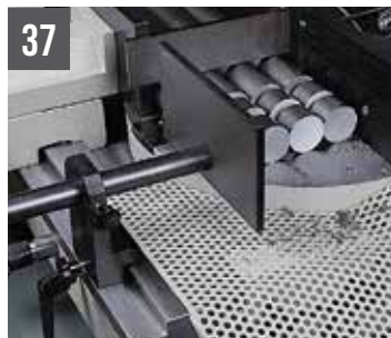
SHARK 332-1 NC 5.0 Guía regulable de descarga de piezas
