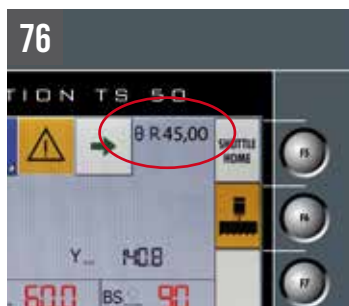
76 SHARK 332-1 NC 5.0 Visualización ángulo de corte
