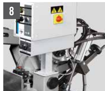
SHARK 282 - KIT CCS Cut Control System (dispositivo para corte sin operador)
