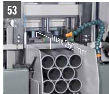
53 SHARK 230-1 NC HS 5.0 Mordazas verticales hidráulicas para cortes en manojos (máx 230x230 mm)
