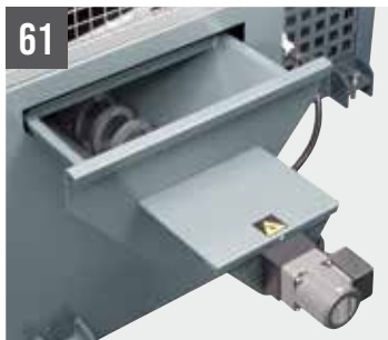
61 SHARK 230-1 / 331-1 NC 5.0 spider Evacuador de virutas con sinfín motorizado
