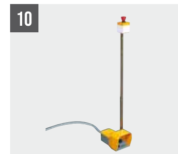
Mando suplementario de pedales con dispositivo de emergencia
