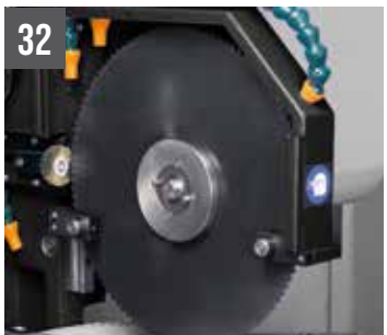
32 TIGER 372 CNC LR 4.0 (Ø max 105 mm) KIT guia da lâmina
