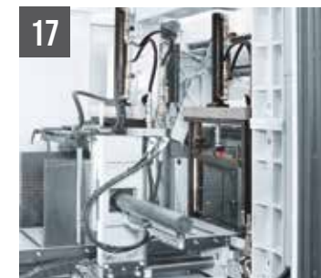
SHARK 350 NC HS 5.0 - Morsas verticais hidráulicas para cortes em feixes (máx 350x350 mm)
