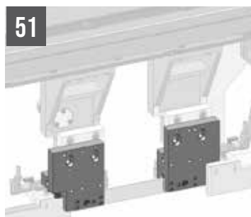
SHARK 350 CNC HS 4.0 / 350 NC HS 5.0 Kit para el montage de cinta de 41mm
