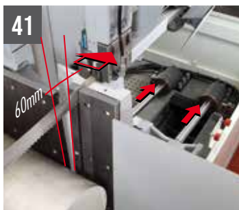
SHARK 660 CNC HS 4.0 - Morsa de corte com mordente posterior retrátil
