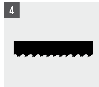
Fita com dentes de matel duro soldados electricamente
