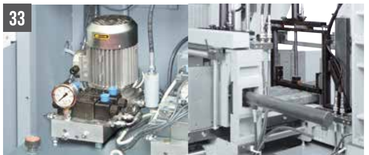
33 SHARK 350 CNC HS 4.0 - SHARK 460 KONNECT Morsas verticais hidráulicas para cortes em feixes (max 350x350 mm)
