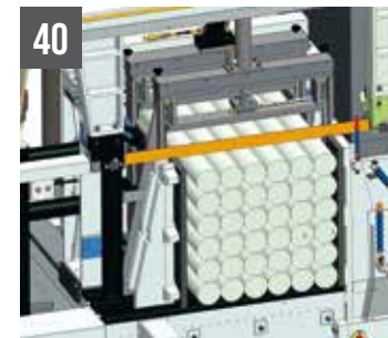
SHARK 660 CNC HS 4.0 - Morsas verticais hidráulicas para cortes em feixes (660 x 660 mm)
