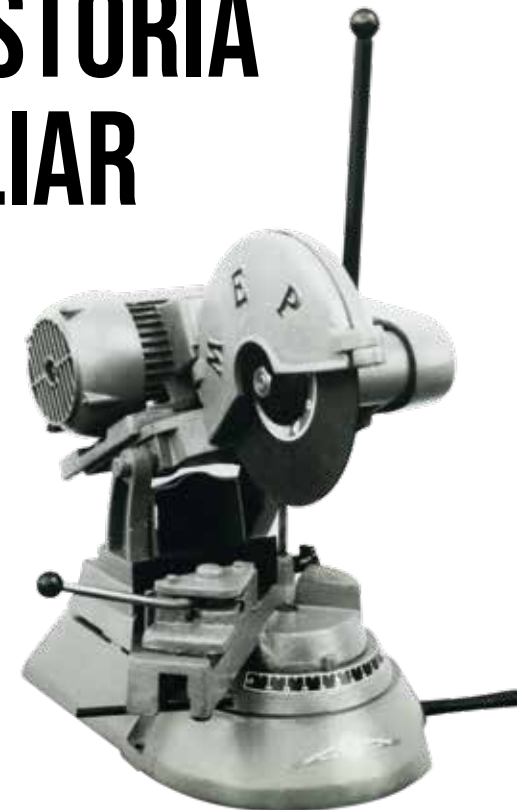
MEP TV 300 O primeiro modelo de serra de disco abrasivo fabricada em série
