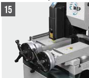
TIGER 372 CNC LR 4.0 Morsa suplementar pneumática
