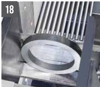
18 SHARK 350 CNC HS 4.0 / 350 CNC HS 5.0 Morsa especial de redução de refugo max 25 mm
